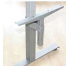
Adapter zur Aufnahme von Verkettungs- und Anbauplatten, Sicherheitsabstand von 25 mm ist gewährleistet, höheneinstellbar von 680–760 mm im Raster von 10 mm
